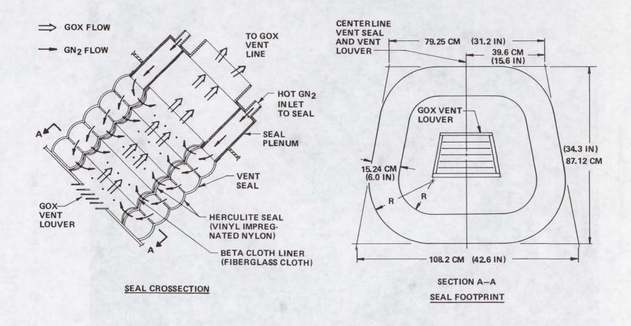
Figure 3. ET GOX Vent Seal
